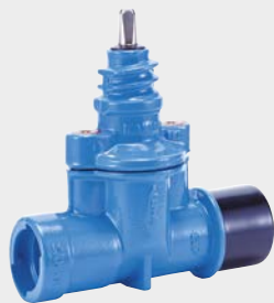
254-00 Vană de concesie cu mufă ZAK® și racord de capăt pentru electrofuziune PE-X
